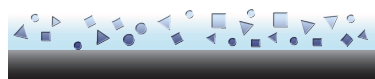
古いワックスフィルムのポリマーを内部から破壊し細かくバラバラにします。
